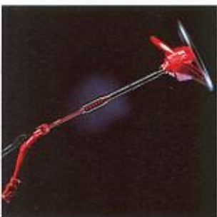
1974 Mehrstufig stoßabsorbierende Lenksäule
