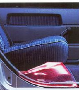
1982 Schutz vor dem "Durchtauchen" unter dem Sicherheitsgurt
