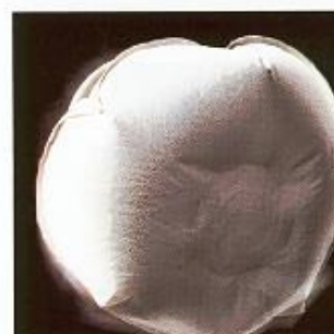
Der 65-Liter-Airbag des Fahrers befindet sich im Lenkrad. Für den Beifahrersitz ist ein 135-Liter-Airbag ohne Aufpreis erhältlich. Bei einem ausreichend starken Frontalaufprall öffnen sie sich im Bruchteil einer Sekunde.
